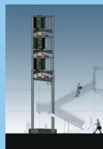
風力発電施設 「サボニウス・ウィンド・タービン」
