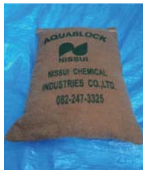
吸水後の土嚢
